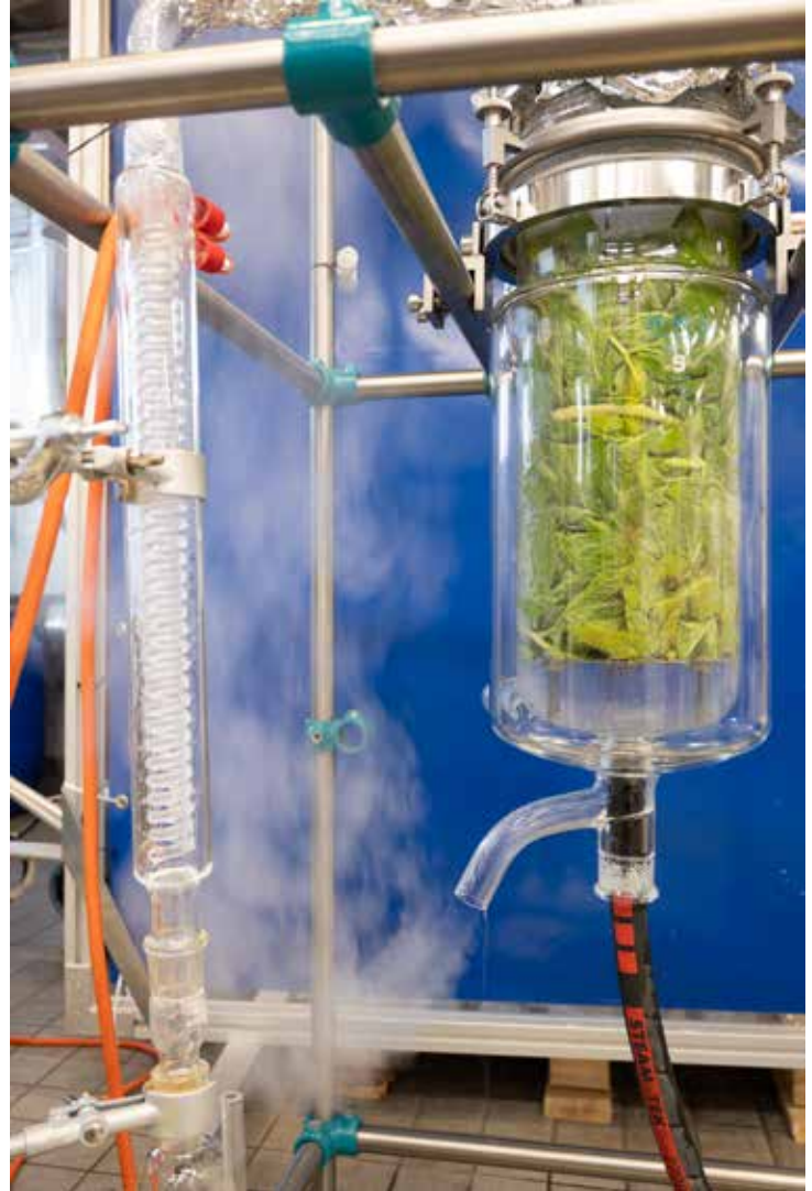
Väinönputken eteeristen öljyjen vesihöyrytislaukokeilu 5 litran lasireaktorissa.
