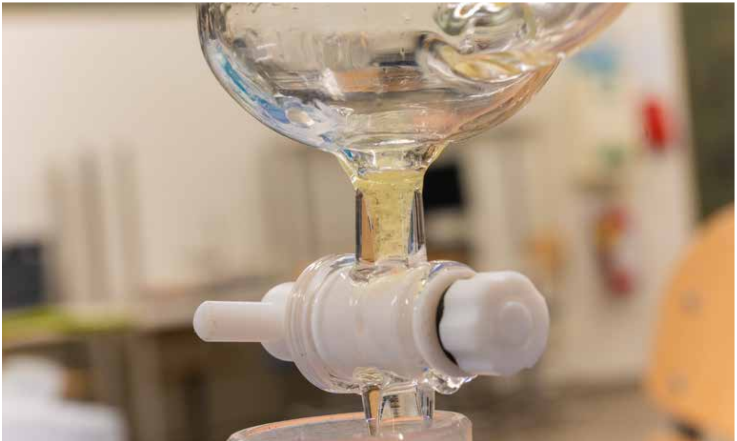
Väinönputken eteeristen öljyjen vesihöyrytislaukokeilu 5 litran lasireaktorissa.
