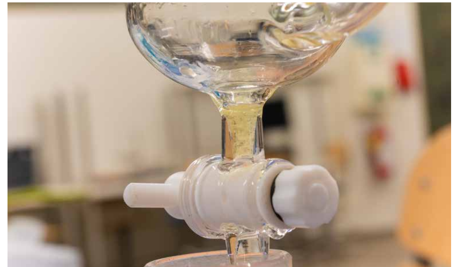
Väinönputken eteeristen öljyjen vesihöyrytisluskokeilu 5 litran lasireaktorissa.
