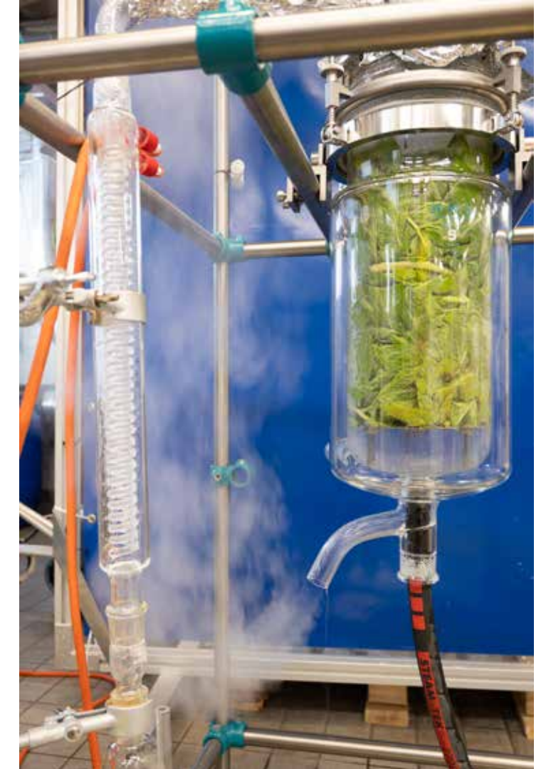
Väinönputken eteeristen öljyjen vesihöyrytisluskokeilu 5 litran lasireaktorissa.
