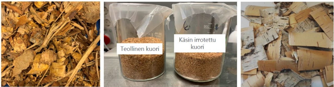
Kuvat 5–7. Vasemmalla teollista kuorimassaa ja oikealla käsin irrotettua ulkokuorta. Keskellä molemmista kuorimassoista jauhetut näytteet. Kuvat ©Risto Korpinen (Korpinen, 2023, dia 24).
